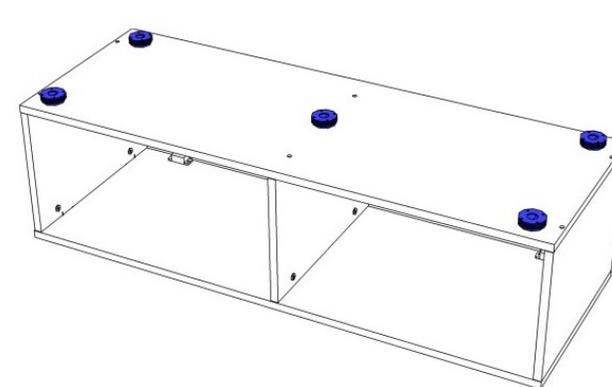
С помощью саморезов 3,5x16 закрепить ответные части опор
