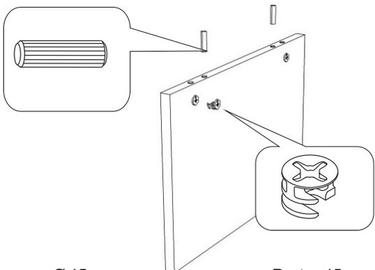
В отверстия Ø 15мм вставить эксцентрики Rastex 15 с направлением стрелки к ближайшему торцу, в глухие отверстия в торцах вставить шканты
