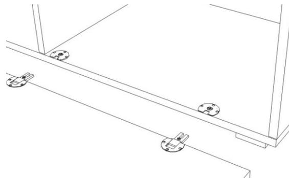
С помощью саморезов которые идут в комплекте с петлями установить и закрепить петли на дно тумбы и дверь
