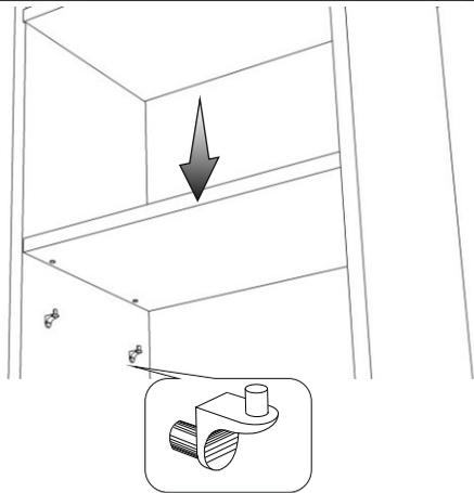
В отверстия Ø 5 мм вставить полкодержатели, установить полки в фиксирующие отверстия
