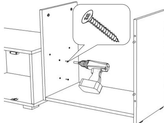
С помощью саморезов 3,5x25 закрепить собранную конструкцию к стойке тумбы
