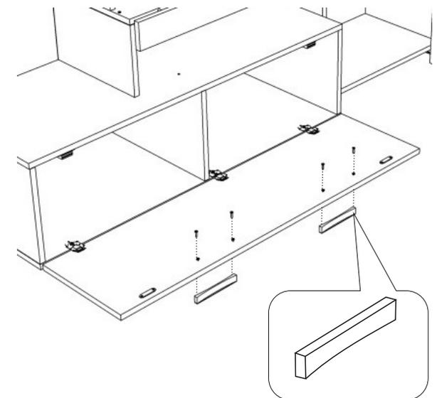
С помощью шурупов идущих в комплекте закрепить ручки
