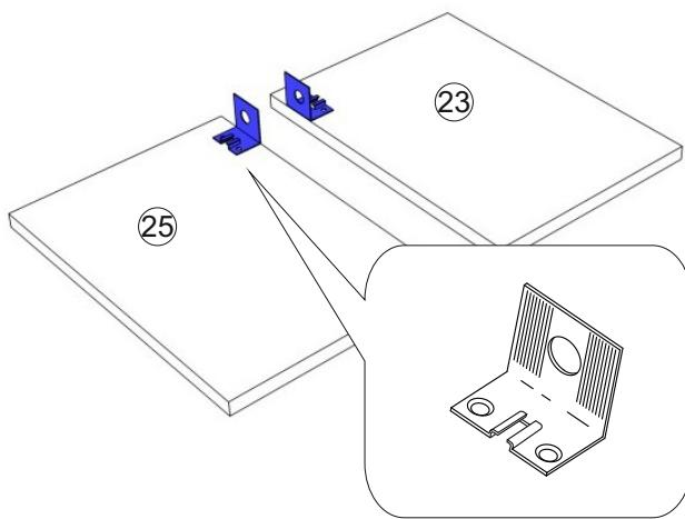
На верхних стойках с помощью саморезов 3,5x16 закрепить основную часть навески
