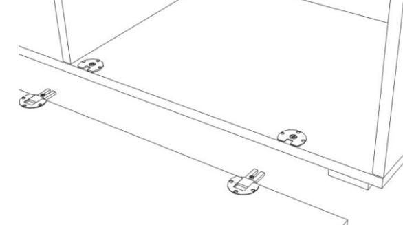
С помощью саморезов которые идут в комплекте с петлями установить и закрепить петли на дно тумбы и дверь
