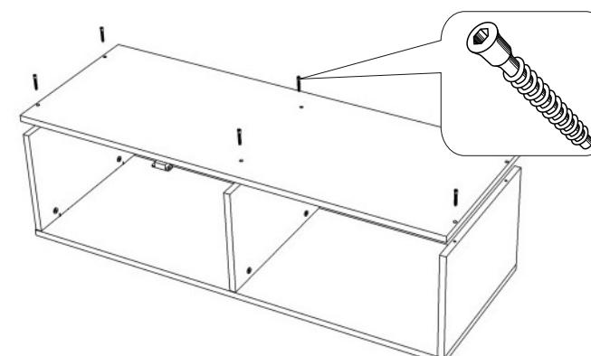
С помощью конфирматов соединить и закрепить между собой стойки и дно
