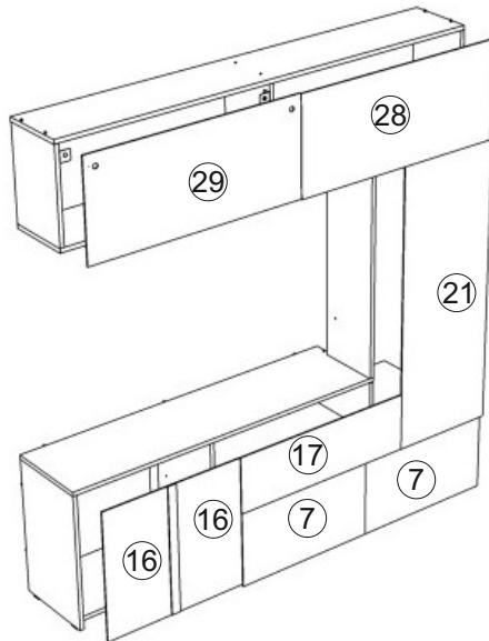
Закрепить задние стенки, стыки закрепить с помощью шайб
