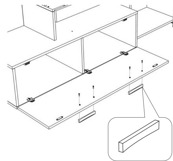
С помощью шурупов идущих в комплекте закрепить ручки
