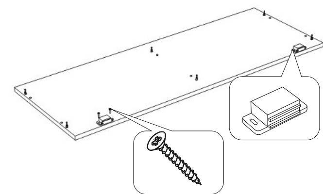
С помощью саморезов 3x16 закрепить к топу магниты
