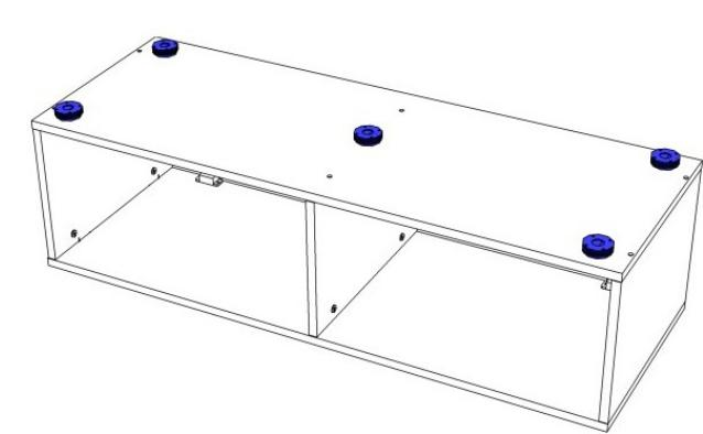
С помощью саморезов 3,5x16 закрепить ответные части опор
