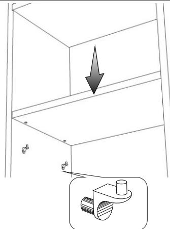
В отверстия Ø 5 мм вставить полкодержатели, установить полки в фиксирующие отверстия
