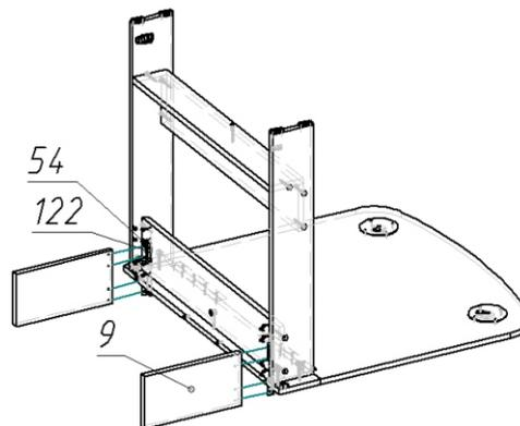
5. Собираем вставную столешницу. Для этого соединяем Дет.2(2шт.) на рояльную петлю(124) саморезами(54) согласно кернениям; Установить шкранты шкрант «мама» с одной стороны столешницы, шкрант «папа» с другой; Закрепить на саморезы(54) замки фиксации столешницы согласно кернениям;
