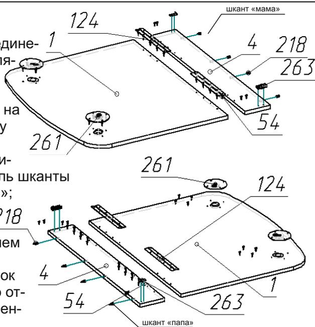
2. Производим сборку каркасов подстолий на евроинты(51) для этого соединяем каркас соответственно схеме так, чтобы кернения под замки фиксации столешниц, так же как и отверстия под стяжку эксцентриковую были обращены внутрь сборки. Закрепить на саморезы(54) замок фиксации столешниц(263) и его ответную часть(зацеп) соответственно кернениям. Установить заглушки на евроинты(56). Второе подстолье собираем симметрично;
