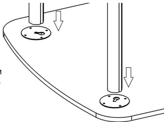
7. Вставить опоры(262) полукруглым болтом в отверстие на фланце(261).
