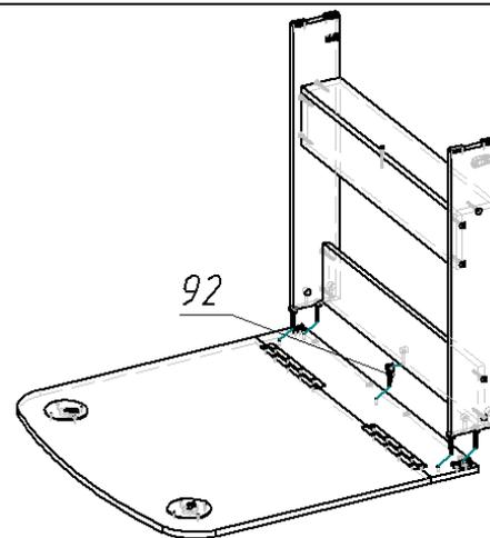
4. Закрепить Дет.9(2шт.) на петли карточные(122) саморезами(54) согласно кернениям к полученным под сборкам;
