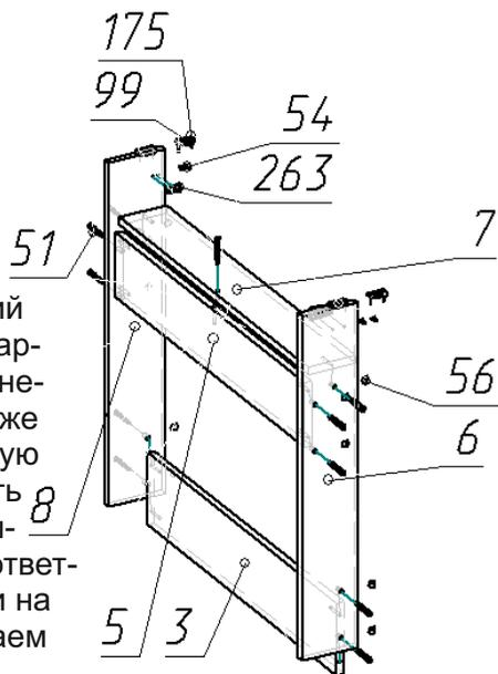
3. Закрепить полученные под сборки как показано на эскизе на стяжки эксцентриковые (92); Второе подстолье со столешницей соединяем симметрично;
