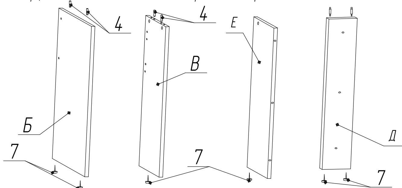
2. В заднюю стенку поз. Г в глухие отверстия диаметром 8 мм. вставить 4 шканта поз. 4(4 шт).
