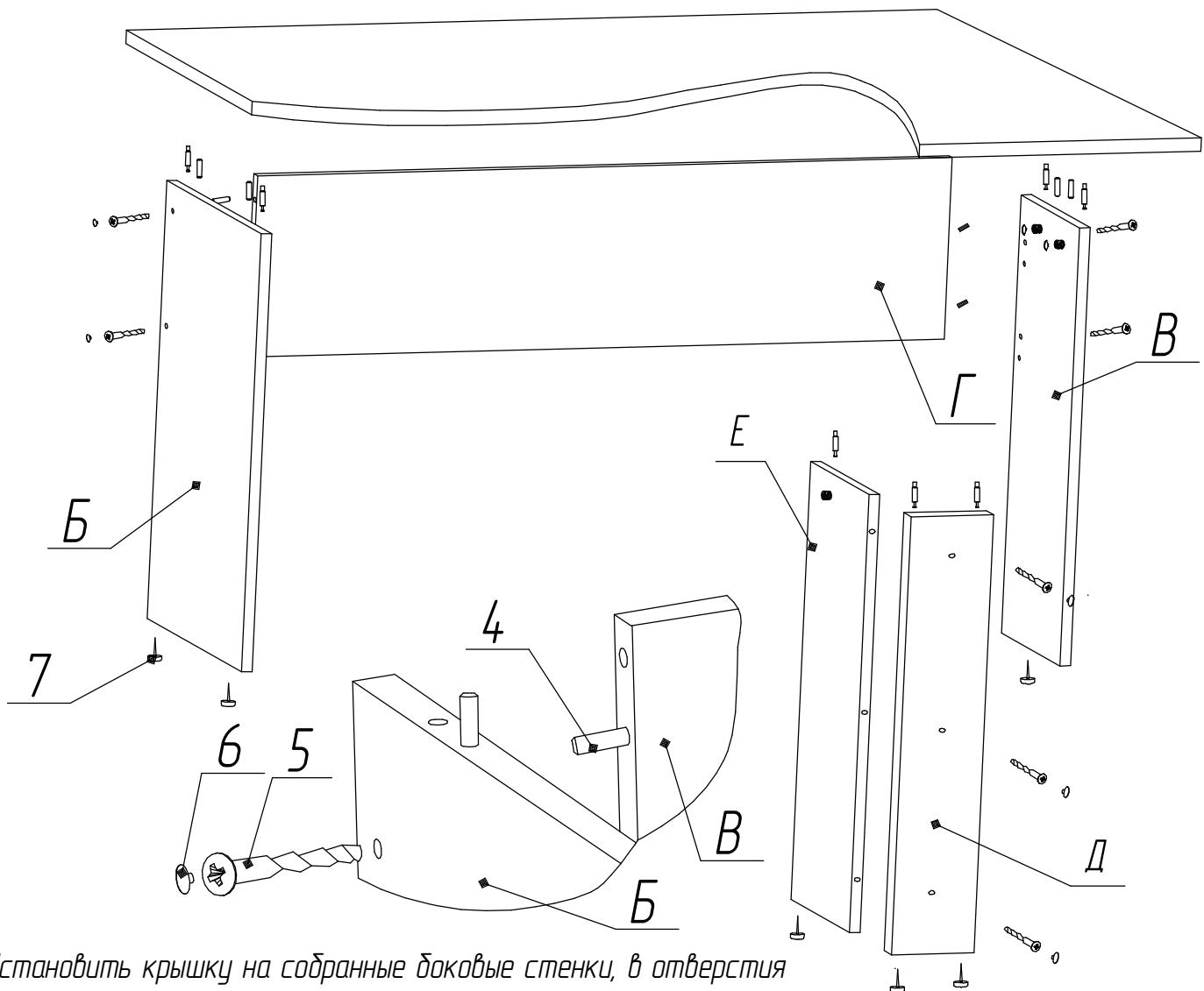
5. Установить крышку на собранные боковые стенки, в отверстия стенок боковых вставить эксцентрики поз.1 и повернуть по часовой стрелке ключом шестигранным поз.8.
